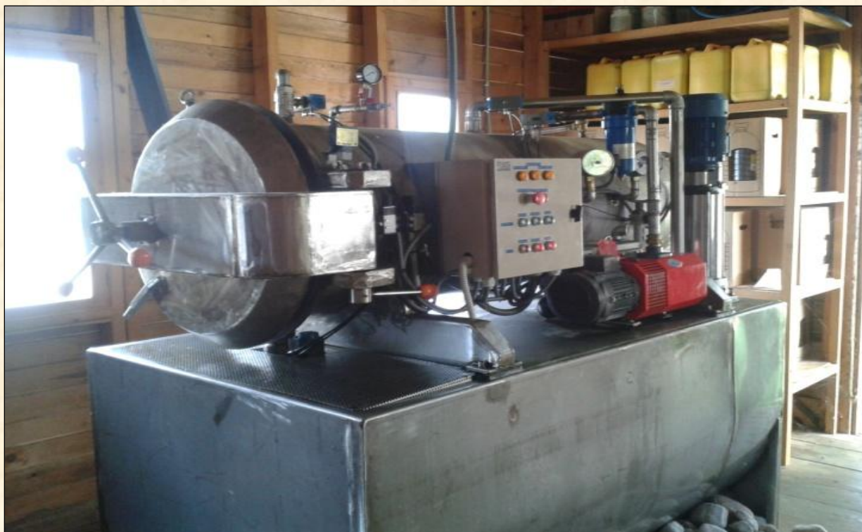
Εργαστηριακός θάλαμος εμποτισμού ξυλείας
